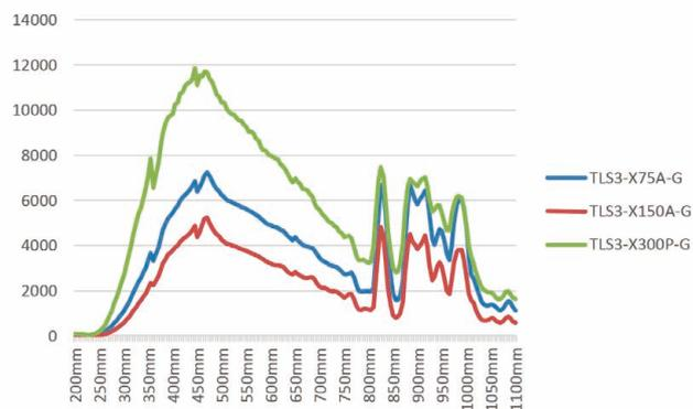
TLS3-X75A-G、TLS3-X150A-G、TLS3-X300P-G的典型输出功率曲线（单位uw，出入狭缝为3mm，光阑高度14mm，光栅600刻线500nm闪耀）
