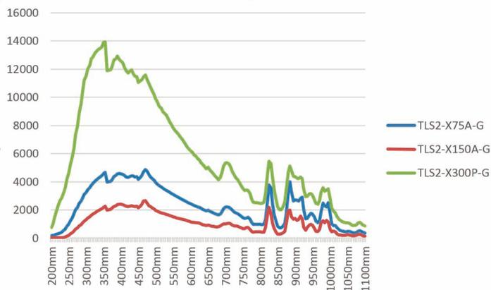
TLS2-X75A-G、TLS2-X150A-G、TLS2-X300P-G典型输出功率曲线（单位uw，出入狭缝为3mm，光阑高度14mm，光栅1200刻线-300nm闪耀）
