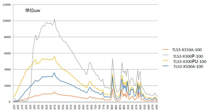
TLS3-X150A-G、TLS3-X300P-G、TLS3-X300PU-G、TLS3-X500A-G的典型输出功率曲线（单位uw，出入狭缝为3mm，光阑高度14mm，光栅1200刻线300nm闪耀）
