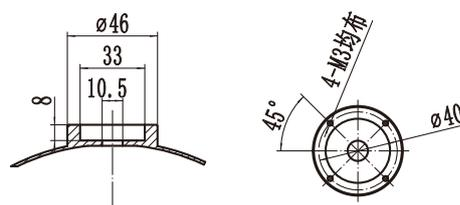
积分球探测器安装法兰尺寸
