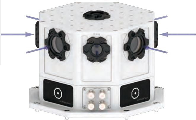
图 1. 样品腔的光学接口：光学窗口空间布局
