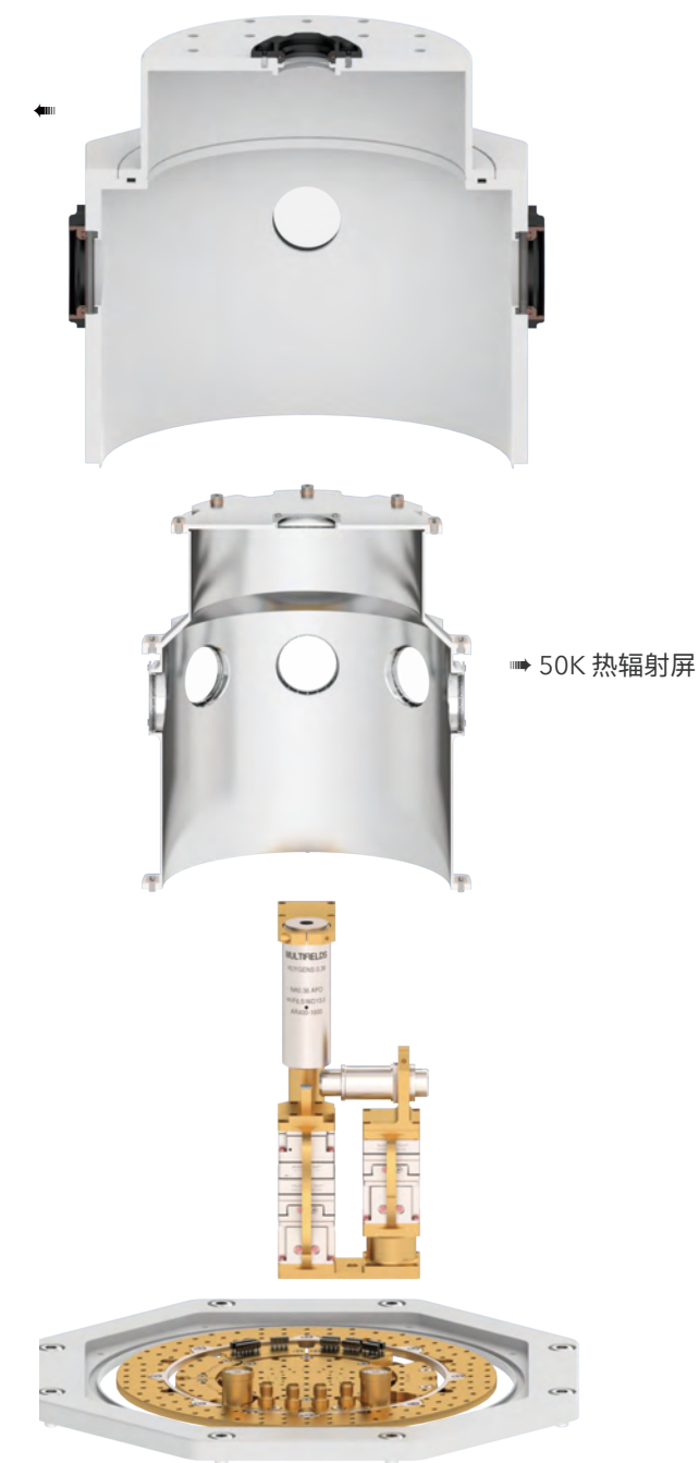
图2.定制热辐射屏蔽罩和真空腔下波导激发实验装置示意图
