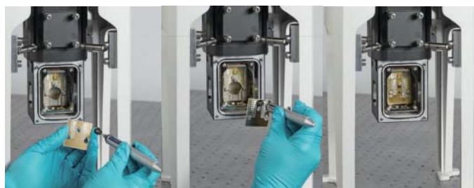
1、2、使用 Dryload 换样工具, 提起电学样品托并移除 3、完成换样
