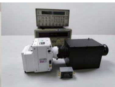
高速 ICCD 实例 (配合 Phantom 高速相机 VEO710L)
