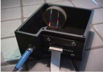
紧凑型设计 - 内置高性能光栅
